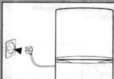
После того, как вы выбрали место для установки вашего холодильника/ морозильника и убедились в том, что предназначенная для его подключения розетка правильно заземлена, выполните следующее:
