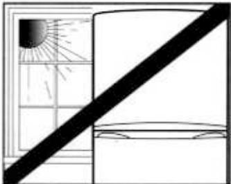
НЕ устанавливайте холодильник/морозильник в местах, подверженных воздействию прямого солнечного света. НЕ устанавливайте его вблизи от источников тепла (кухонная плита, радиатор отопления). Если вам необходимо установить холодильник/морозильник рядом с источником тепла, обеспечьте достаточную теплоизоляцию между двумя бытовыми приборами.
