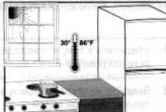
Не устанавливайте изделие в местах, подверженных воздействию прямого солнечного света или рядом с нагревательными приборами, радиаторами отопления, печами или кухонными плитами.
