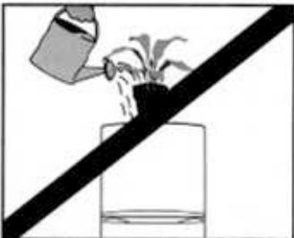
НЕ допускайте, чтобы на заднюю стенку холодильника/морозильника попадали брызги воды и не проливайте воду на заднюю стенку. Вода ухудшает изоляцию электрических элементов изделия и может вызвать электрическое короткое замыкание или создать риск поражения электрическим током.
