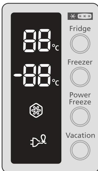
При первом включении питания все освещение устройства включится на две секунды. В холодильной и морозильной камерах будут установлены температурные значения в 5 °C и -18 °C соответственно.
