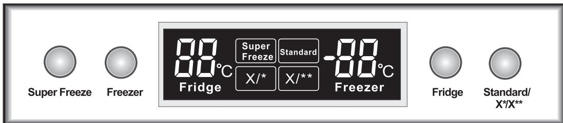
◆ Користувач може завдати температуру камери за необхідністю, в принципі, можна завдати на 5° С, при погоді з високою температурою – можна встановити в діапазонах 5–6° С, при погоді з низькою температурою – можна встановити в діапазонах 3–4° С.
